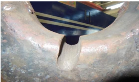
磨损后的吊钩照片（已报废）
