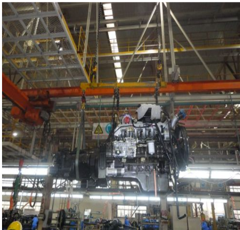
图示：发动机、驾驶室在线设备随总装配线同步进行落装
