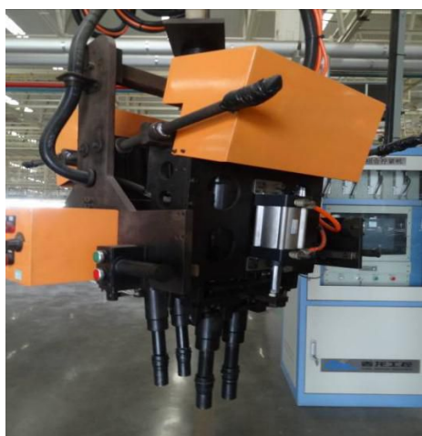
图示：斜向进给的拧紧机
