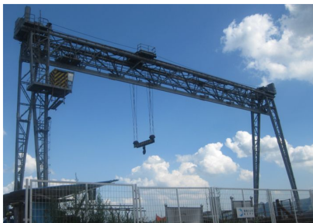
图 1.13 俄罗斯扎波罗日动力机械厂制造的 KC50-42B 型门式起重机
