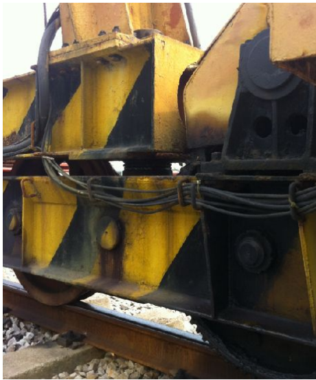
图 1.10 刚性支腿、柔性支腿与横梁及台车的联接方式
