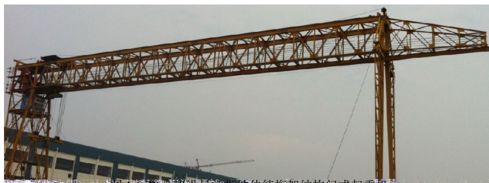
图 1.6 电力建设最常见的传统桁架结构门式起重机
