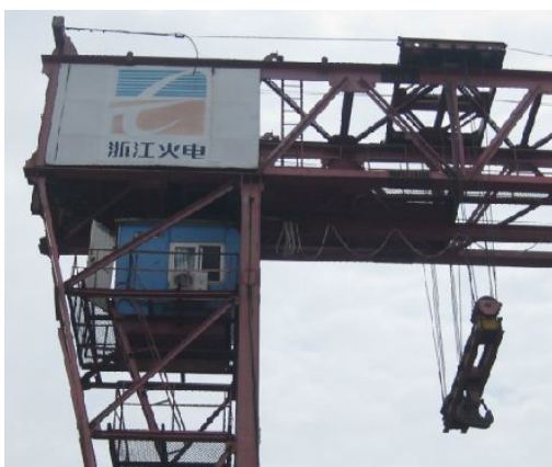
图 1.8 刚性支腿与主梁螺栓连接图
