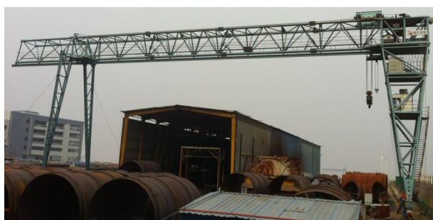
图 1.13 俄罗斯扎波罗日动力机械厂制造的 KC50-42B 型门式起重机
