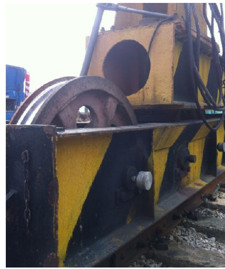
图 1.10 刚性支腿、柔性支腿与横梁及台车的联接方式
